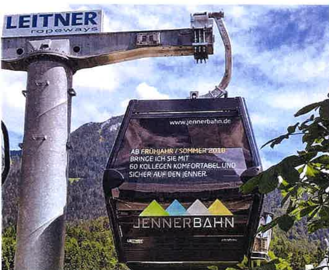
Ab der Sommersaison 2018 wird unter anderem eine 10er-Kabinenbahn als Hauptzubringer die Gäste in zwei Sektionen auf den rund 1800 Meter hohen Jenner-Gipfel bringen.
